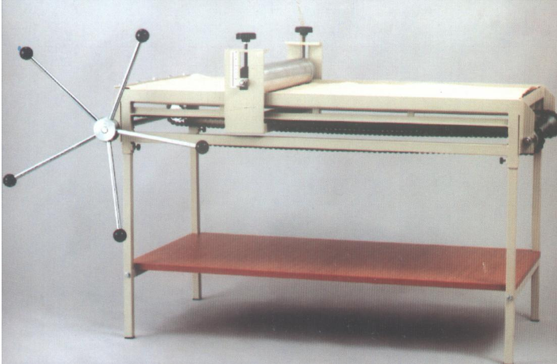
Das Gestell besteht aus massivem, lackiertem Stahlrohr. Die Walze besteht aus einem verzinkten Stahlzylinder. Die Plattenstärke lässt sich stufenlos von 1 - 70 mm (genau ablesbare Maßskala) durch Verstellen von zwei Handrädern einstellen. Der Ton wird zwischen das mitgelieferte Grobleinen gelegt. Der Schlitten der Stahlwalze wird durch ein großes Handrad angetrieben.
